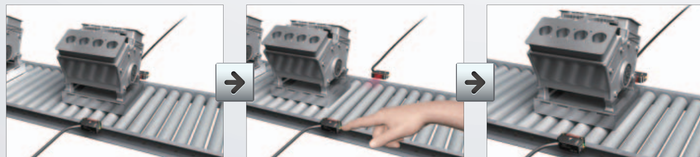
检测物体有缝隙, 反射光乱反射且穿过缝隙, 检测不稳定。
